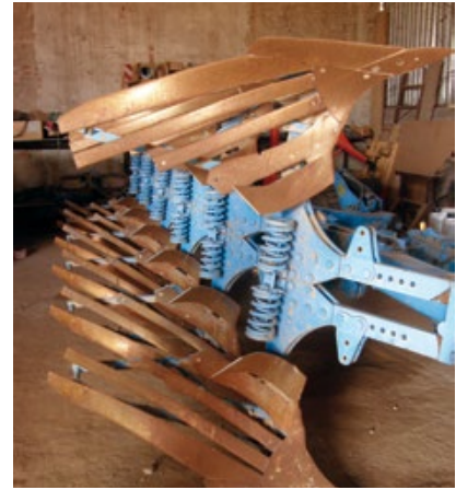
De ploeg Vari-Diamant 10 is uitgerust met een non-stop veerbeveiliging en met strokenristers. Na zes jaar op leemgronden gebruikt te zijn, hoefde nog geen enkel rister vervangen te worden.
